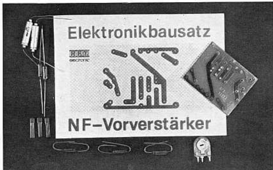
Bild 3: Begonnen wurde mit der Auslieferung der ersten 3 Elektronikbausätze. Unser Foto zeigt den kompletten Bausatz Nr. 20. Jeder Bausatz besteht aus der gelochten Leiterplatte, den passiven und den aktiven Bauelementen sowie der ausführlichen Beschreibung für den Aufbau des Bausatzes und für seinen Einsatz in der Praxis des Elektronikamateurs
