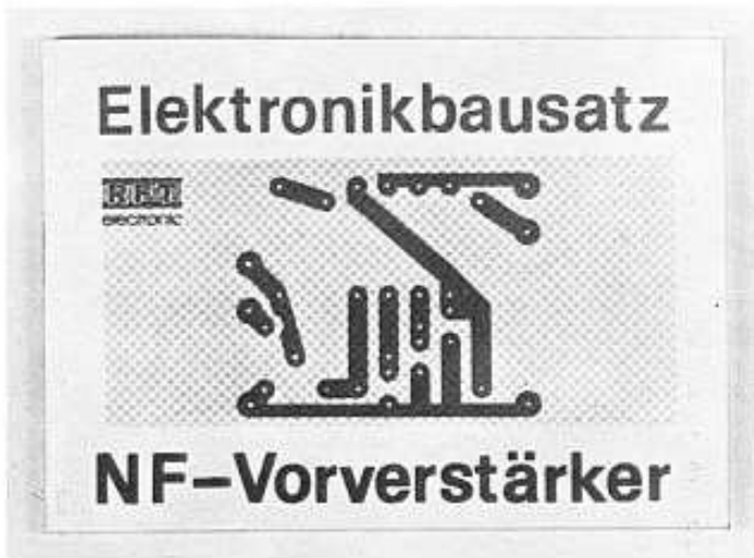
Bild 4: Der Elektronikbausatz „NF-Vorverstärker“ ist der Bastlerbeutel Nr. 20. Er kostet 6,50 M. Es ist ein 3stufiger Si-NF-Vorverstärker, dessen Verstärkungsfaktor größer 1000 ist. Bei der Betriebsspannung 9 V ist die Stromaufnahme etwa 5 mA
