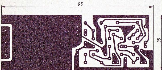
Bohrungen  $\phi 1\text{mm}$ ;
