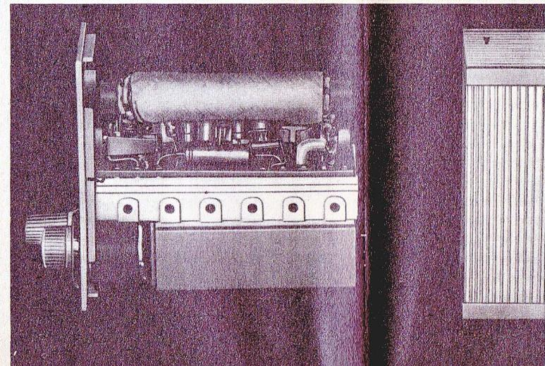
Bild 20 Innenansichten des elektronischen Schalters
