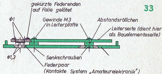
Bild 33 Gestaltung der Anschlüsse in der Musterbox (Gleichspannungs- und Steuerseite)
