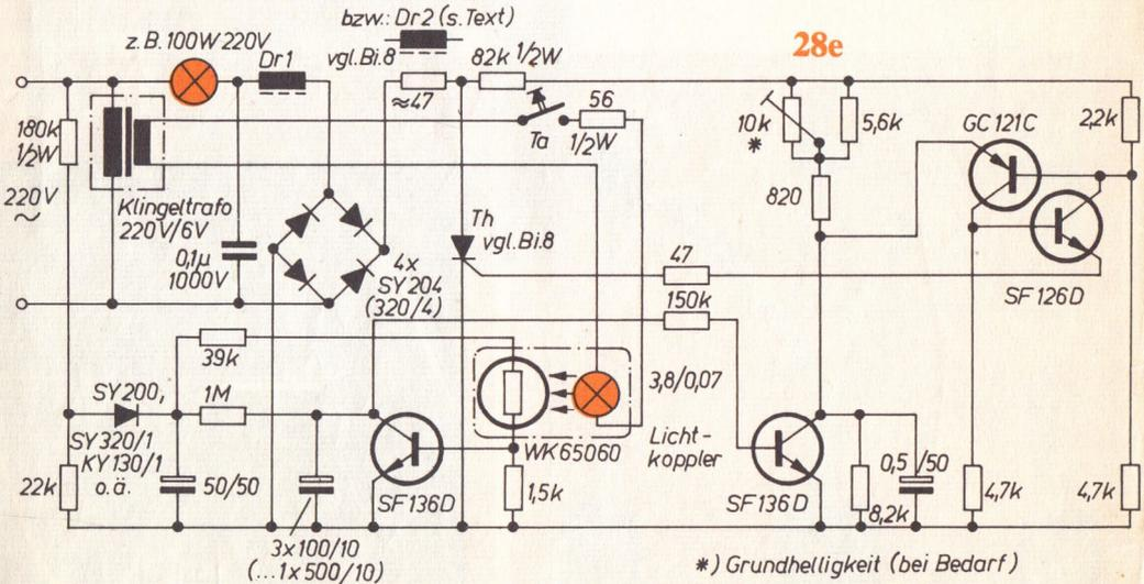
b) über schwachstrombetätigten Lichtkoppler geschalteter Zusatz für Schaltung nach Bild 16, c) Gesamtschaltung eines vollelektronischen Treppenlichtautomaten mit Lichtkoppler, Variante Halbwellenbetrieb (110-V-Lampen am 220-V-Netz),
