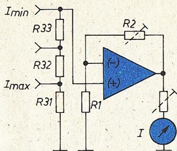
$$R_{31} + R_{32} + R_{33} = R_3 \approx R_1 \parallel R_2$$
