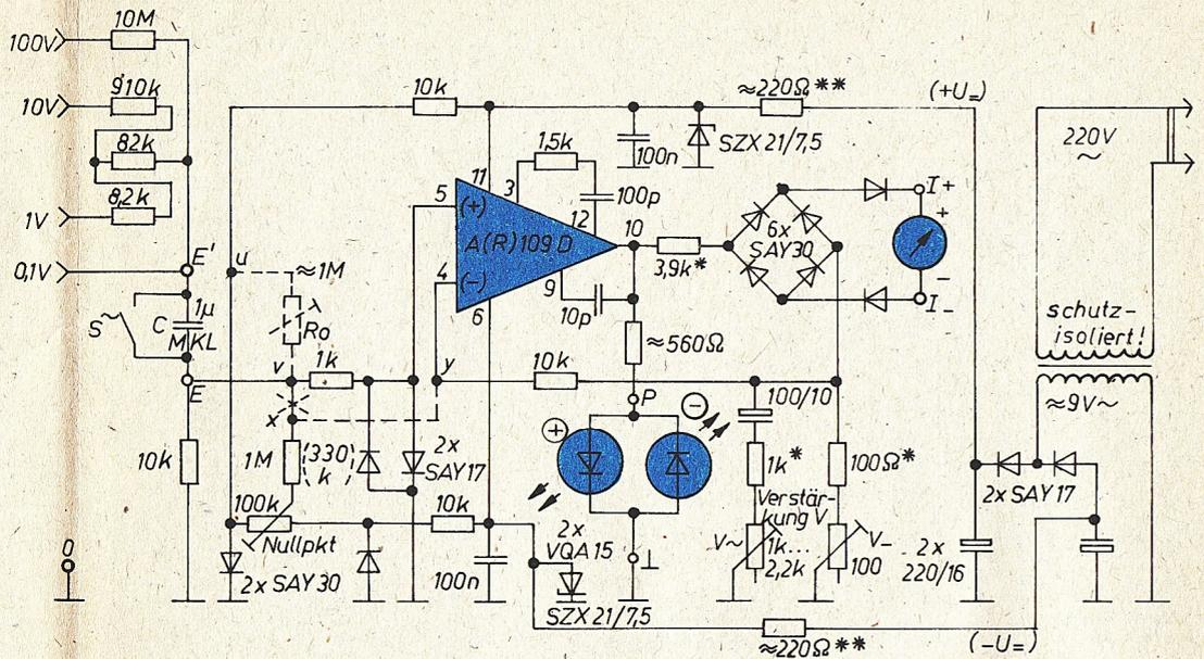
\*) Werte für Meßwerk mit  $I_T = 0,5\text{ mA}$ ,  $R_{Cu} \approx 105\Omega$
