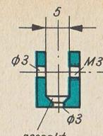
gesenkt für M3-Senkschraube (Kopfdurchmesser → max. 5!)
