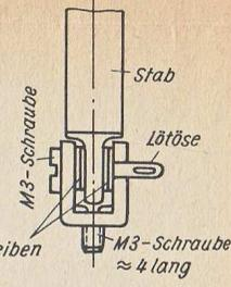
Bild 30 Vorschlag für die Halterung der Teleskopantenne
